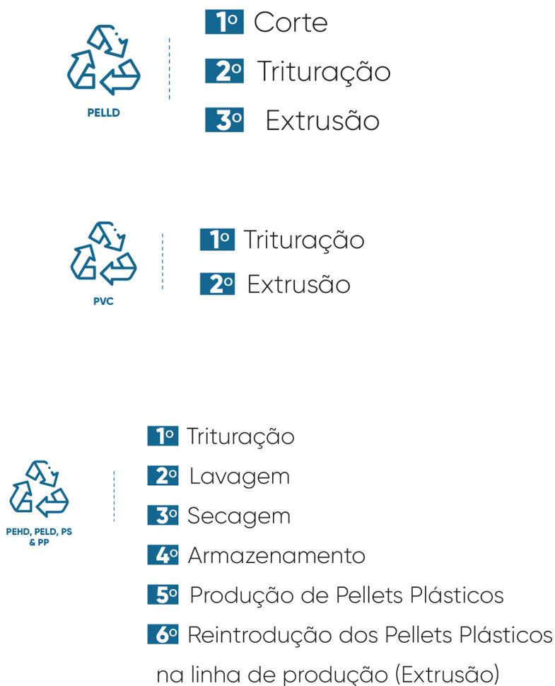
**Figura 2** - Processo Reciclagem interna dos materiais PELLD, PVC, PEHD, PELD, PS e PP
