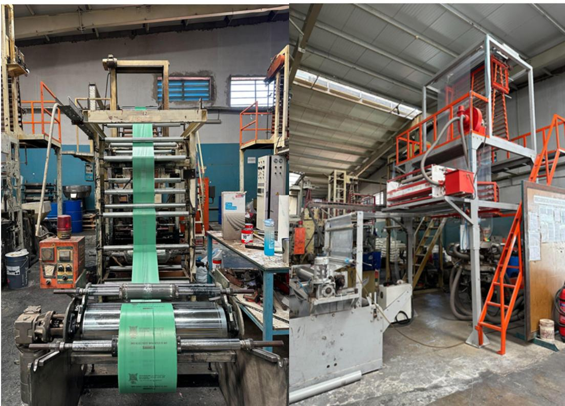
**Imagem 3 - Máquinas de Extrusão de Plásticos Polietileno**
